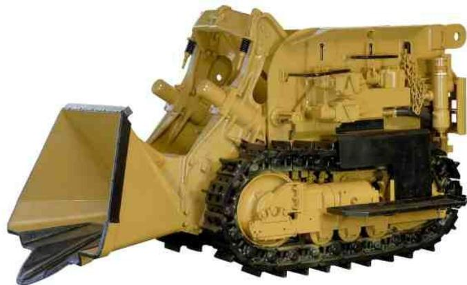
در کنار لودر محلی برای ایستادن اپراتور تعییه شده است که به آن رکاب لودر میگویند تا فرد بتواند روی آن ایستاده و به لودر فرمان دهد و آن را حرکت دهد که کل مرکز فرمان لودر همین قسمت است که به صورت 2 دسته شکل قرار دارد .
