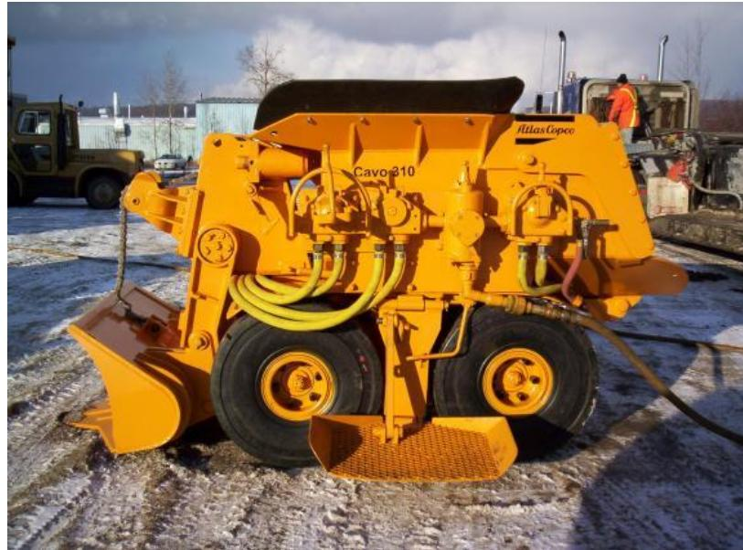
نیروی حرکتی لودر ها به دو صورت پنوماتیکی (هوای فشرده) و الکتریکی میباشد که در ایران به جز تعداد اندکی لودر خاکبرسر الکتریکی مابقی پنوماتیک هستند که البته روند افزایش لودر خاکبرسر الکتریکی رو داریم و دلیل استقبال از آنها نیروی برق ارزانتر نسبت به تولید هوای فشرده و همچنین هزینه تعمیر و نگهداری پایین تر و زیادتر بودن و ارزان بودن قطعات الکتریکی نسبت به قطعات یدکی موتورهای بادی است .
