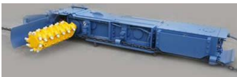
شکل 5. نمایش هدکاتر و محرک زنجیر کش
